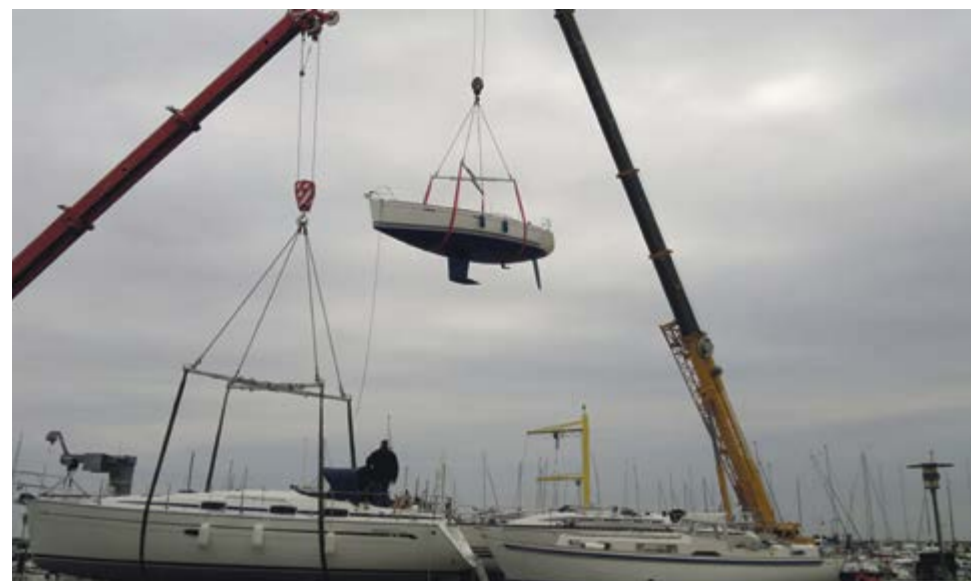
Store krandag i Vedbæk. 2 mobile kraner tager fat: En gnidsningsfri ilandtagning af en sejlbåd kan klares på ca. 12 minutter.
